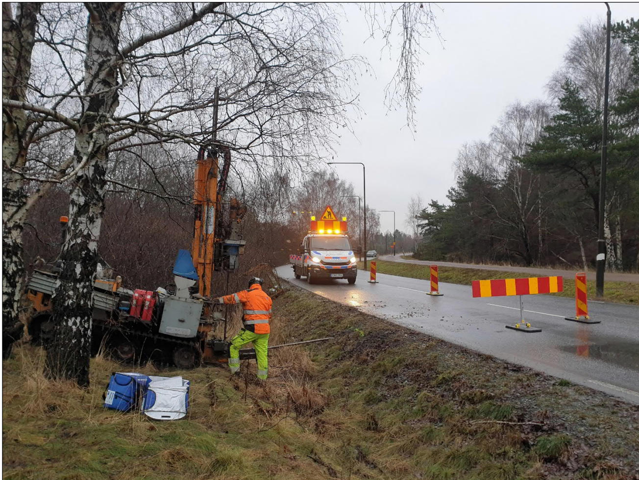
Figur 8 Jordprovtagning med borrhandsvagn i provpunkt NC2106. Förening av PAH över MKM påträffades på 1,5-1,9 meter under markytan.
